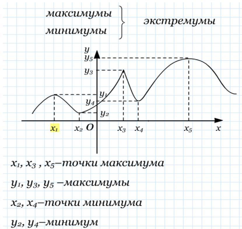
Рисунок 74 –Графическое изображение экстремумов
