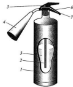
Рисунок 1.1 – Конструкция переносного газового углекислотного огнетушителя: 1 - корпус; 2 - сифонная трубка; 3 - заряд ОТВ (диоксид углерода); 4 - раструб; 5 - запорнопусковое устройство; 6 - предохранительная чека; 7 - ручка для переноски
