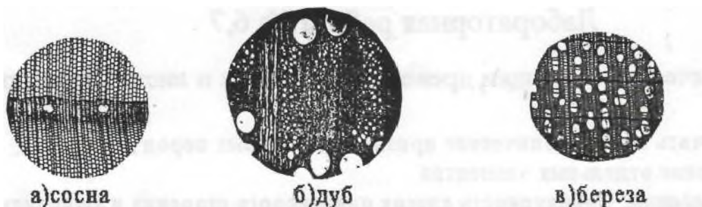
Рисунок 8 – Различия в микроскопическом строении хвойных и лиственных пород
