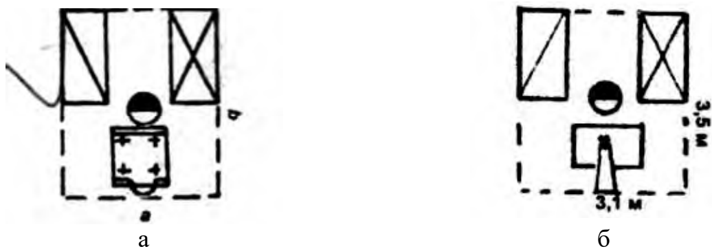
Рисунок В.5 – Условное обозначение фрезерных станков а- ФС-1, б – ВФК-2
