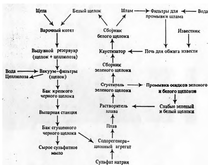
Рисунок 8 -Схема регенерации щелоков сульфатного производства целлюлозы
