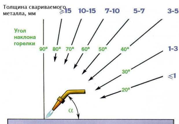
Рисунок 6 – Угол наклона мундштука горелки в зависимости от толщины металла
