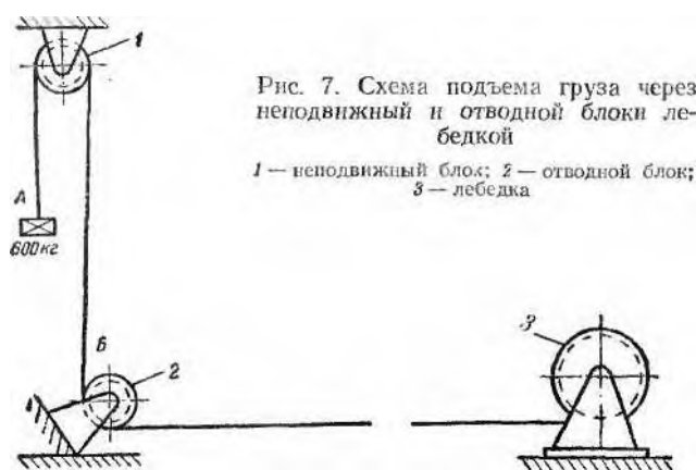
Рисунок 1 – Схема подъема груза через неподвижный и отводной блоки лебедкой
