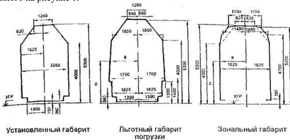
Рисунок 1 - Габариты погрузки грузов в железнодорожные вагоны
