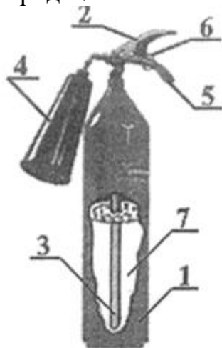
Рисунок 3 - Устройство переносного углекислотного огнетушителя.
