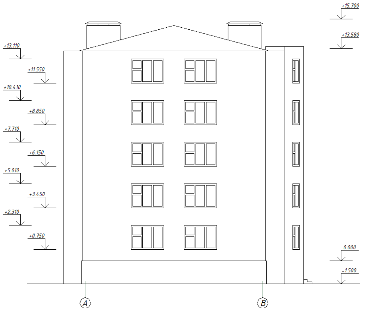
Рисунок 6 - Фасад А-В после реконструкции
