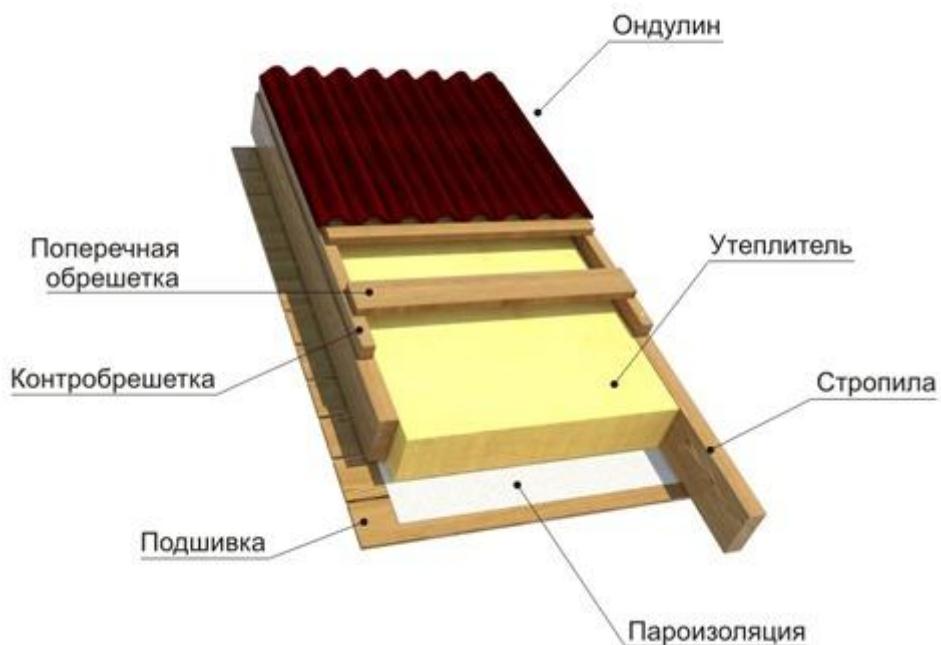
Рисунок 62 – Конструкция кровли из «Ондулина»
